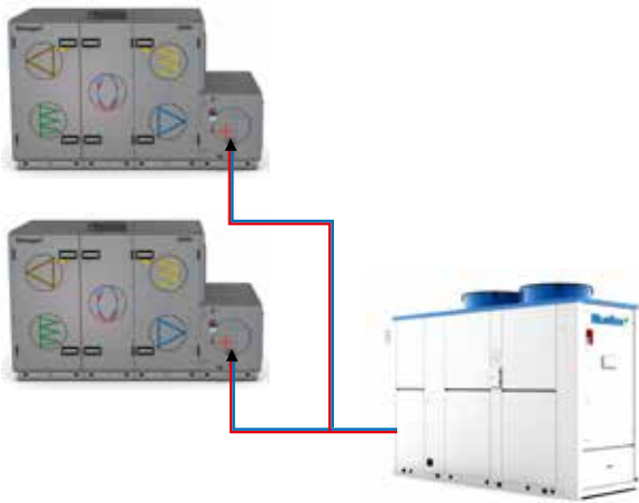
Beispiel 1. Reversible Wärmepumpe produziert Wärme und Kälte für 2 GOLD-Lüftungsgeräte.
